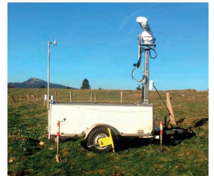
Radar utilisé pour étudier la migration des oiseaux
