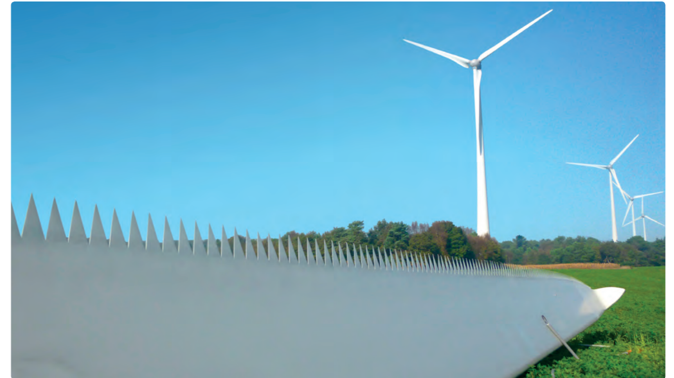
Exemple de pale équipée de peignes, un système novateur pour limiter le bruit
